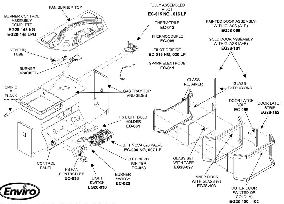
EG28 DOOR AND GAS TRAY ASSEMBLY EXPLODED
